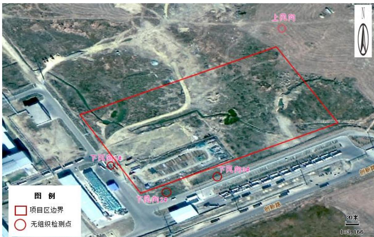
图 2.1 厂界无组织废气检测点位图
