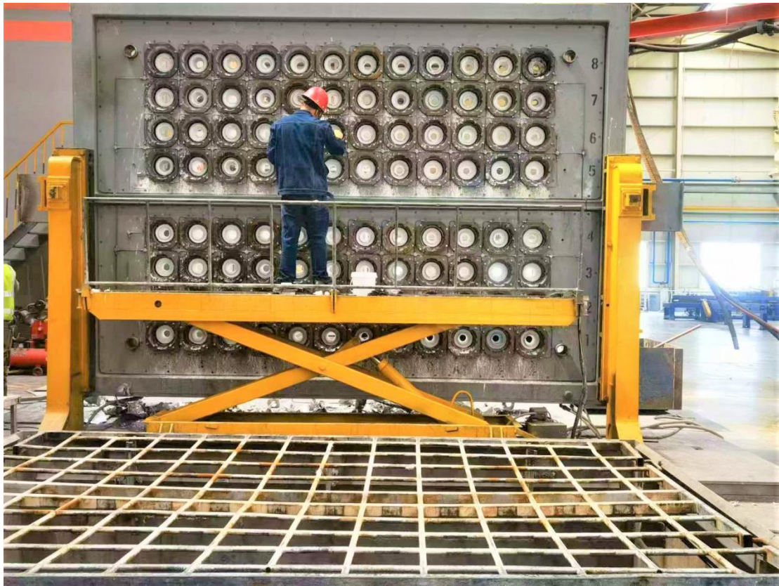
图 4-2 双石墨环油气润滑工装
